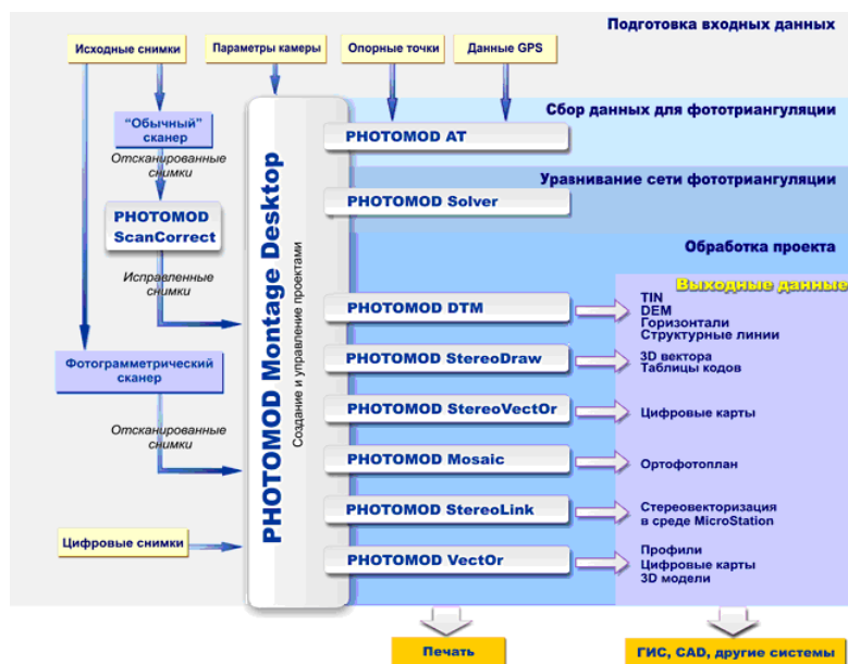
6-сурет-PHOTOMOD жүйесінде жобаны өңдеудің технологиялық схемасы.
